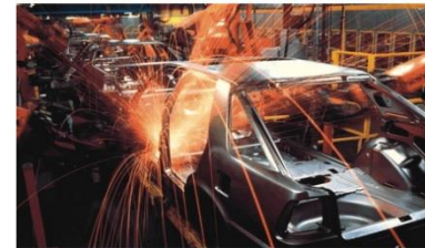
图3 某汽车点焊过程通过电极夹紧力进行质量监控
